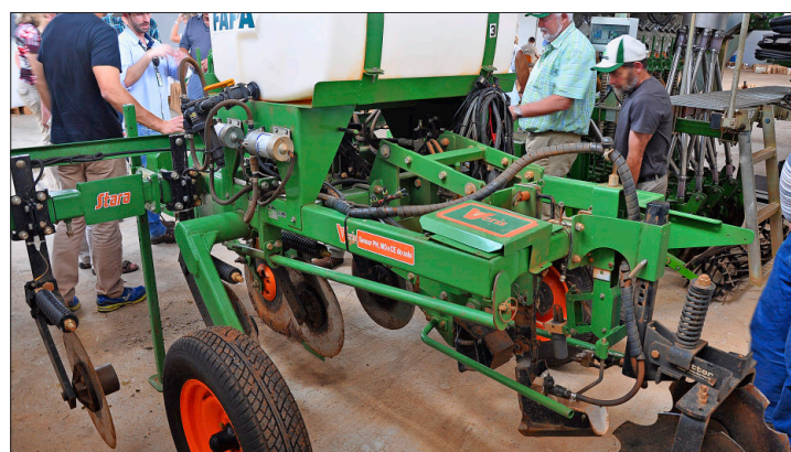
Dieses Gerät der Forschungsanstalt FAPA misst das Produktionspotenzial des Bodens für die Erstellung von Bodenkarten.
