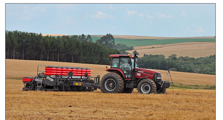
Soja-Saat mit GPS. Die Direktsaat ist in Brasilien zur Vermeidung von Erosion durch die heftigen Regenfälle weit verbreitet.
